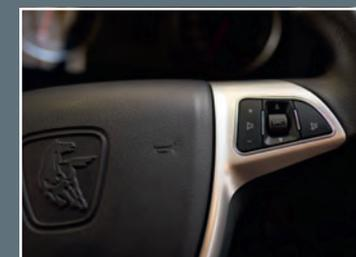
Регулировка звука и его источника
