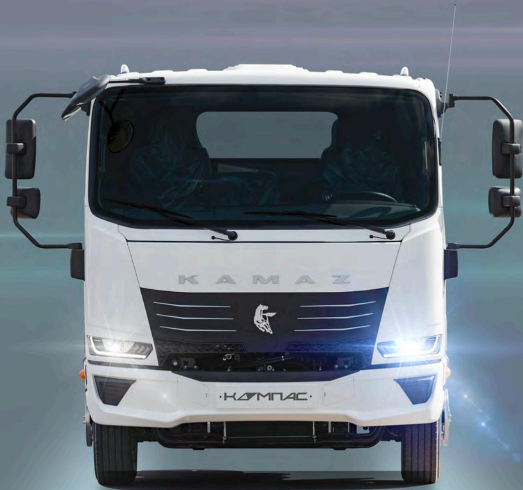
КОМПАС 5 — компактная и перспективная модель семейства — предлагает множество преимуществ для маневренного вождения и эффективной работы. На модели КОМПАС 5 полной массой до 3,5 т. и КОМПАС 6 — до 5,6 т. устанавливаются 4-цилиндровые дизельные двигатели КАМАЗ-580 объёмом 2,2 л, мощностью 122 л.с. и с крутящим моментом 320 Нм, а также 5-ступенчатая механическая коробка передач.
